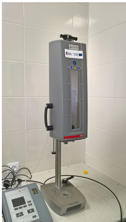
Urządzenie służące do pomiaru zawartości dwutlenku węgla z uwzględnieniem temperatury i ciśnienia
